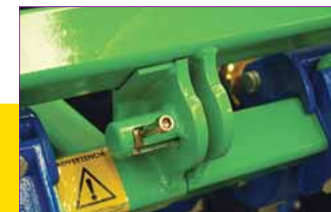
Bulón de cierre de alta seguridad para los cuerpos plegados.
