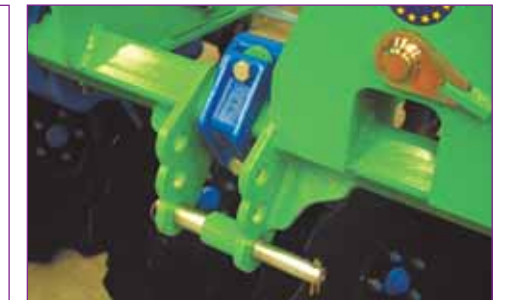
Enganche de bulones para bola de 28 o de 37 mm.
