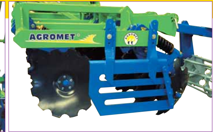
Protector delimitador regulable en altura.
