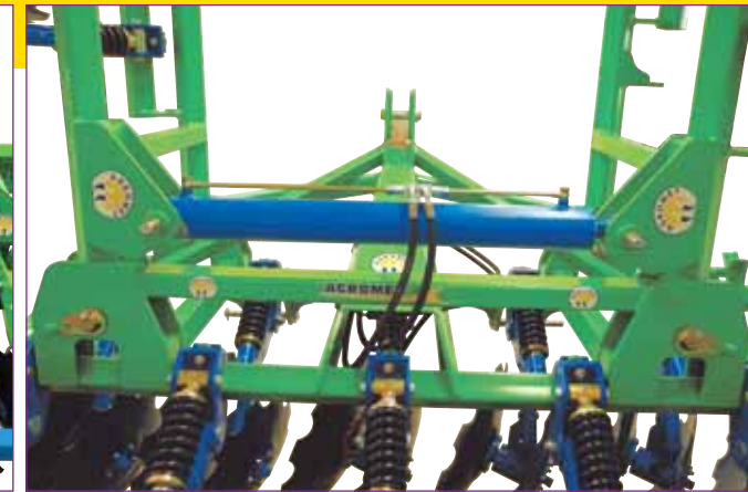
Sistema de plegado con válvula pilotada.
